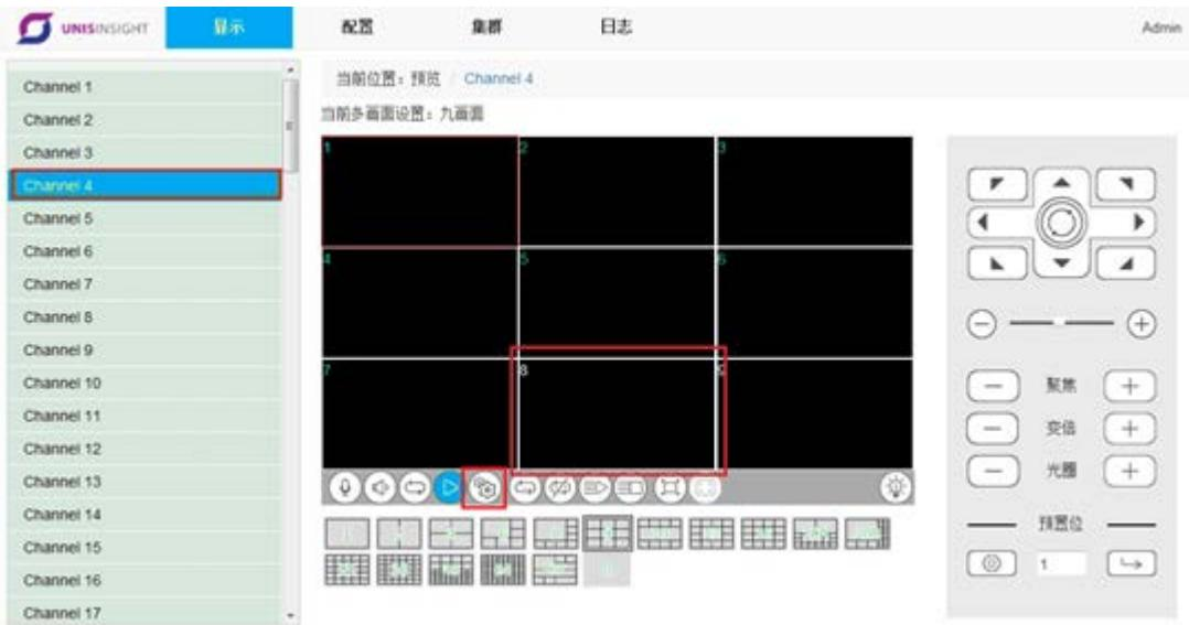
下图为通道 4 画面 8 的添加界面。左半侧界面的最下方有两个按钮，左边<sup>⑧</sup>为手动添加。点击此按钮，打开前端设备的编辑界面。选择“设备类型”、“连接模式”，填写对应的“服务器地址”等必要信息，点击“保存”，该前端设备即被添加到切换列表中。
