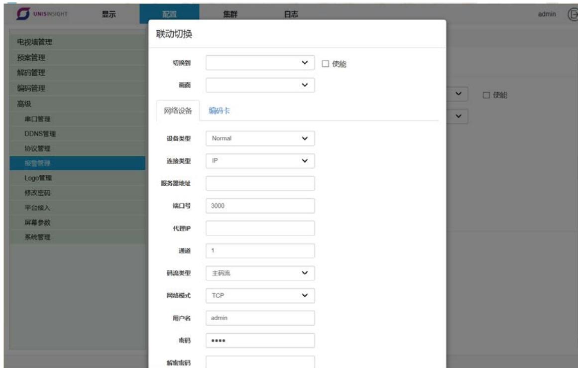
解码器支持视接收频丢失，端口报警，移动侦测三种前端报警，前端报警可联动本地端口输出。有警情产生时，显示器上对应警情的报警灯变成红色。
