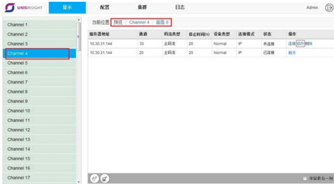
被添加好的列表，若需要更改其中某个前端设备的信息（如 ip 地址，主副码流等），也是可以操作的。在显示界面中，选择某个通道的某个画面双击，或点击配置按钮进入前端设备添加界面。在列表中找到要修改的项，点击该项后面对应的“修改”即可进行编辑。若要删除此项，直接点击后面的“删除”即可。
